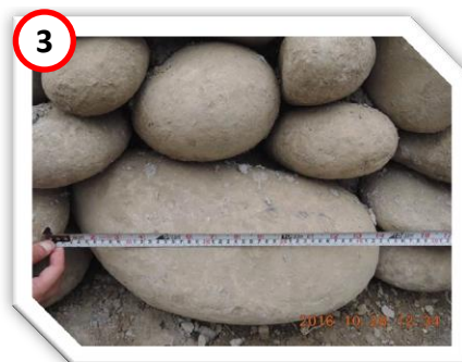
卵石寬度43cm，超過40cm，不符合設計圖需求。
