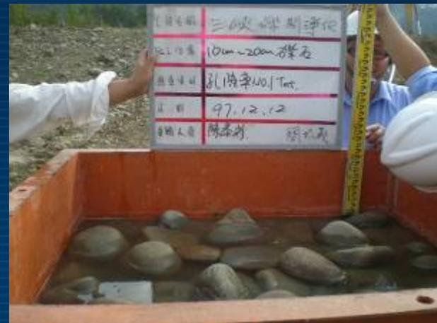
孔隙率量測
