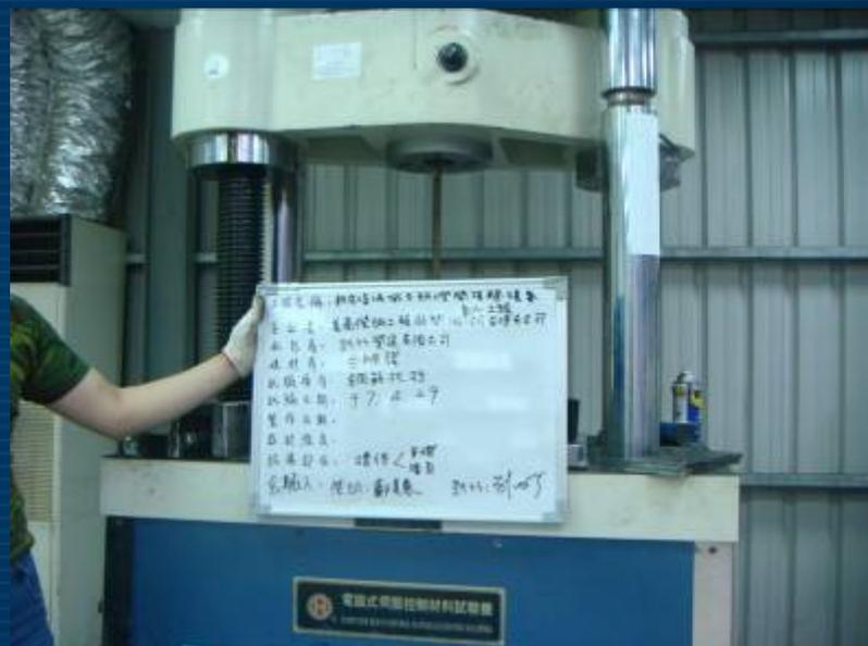
鋼筋抗拉試驗
