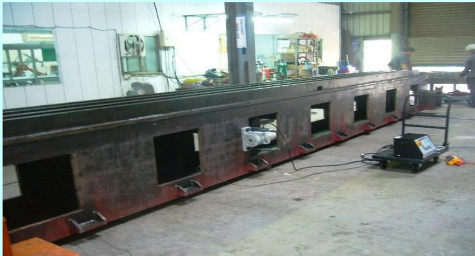
以振動方式消除鋼結構件殘留應力
